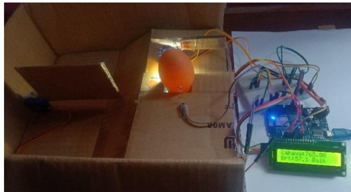
Gambar 7. Implementasi Hardware Pada Telur Berkualitas Baik
