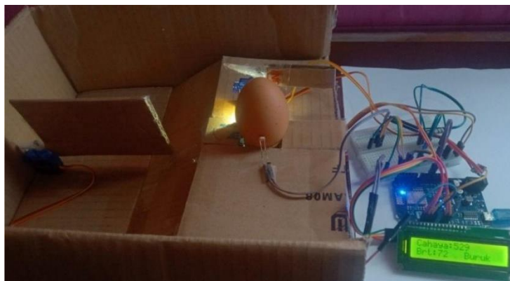
Gambar 8. Implementasi Hardware Pada Telur Berkualitas Buruk
