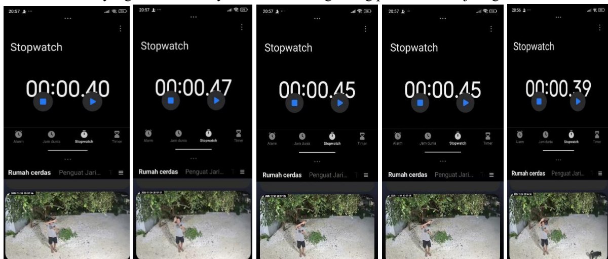
Gambar 7. Pengujian Timestamp untuk mengukur latensi video
